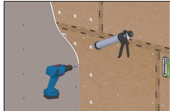
**9** Финишный слой крепится универсальными саморезами 5 × 45 к гипсоволокнистому листу с усилением соединения при помощи точечного нанесения герметика **SoundGuard Seal**. При этом важно избегать попадания саморезов в металлический каркас конструкции.
