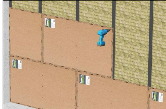
**6** Шляпка самореза слегка утапливается и изолируется от прямого соприкосновения с облицовочным гипсокартонным листом с помощью герметика **SoundGuard Seal**.
