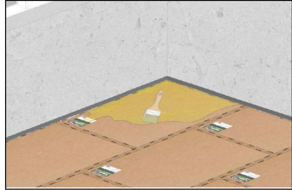
**4b** После просушки на панели **SoundGuard** монтируется армированная стеклосеткой стяжка из пластичного плиточного клея толщиной не менее 6 мм.
