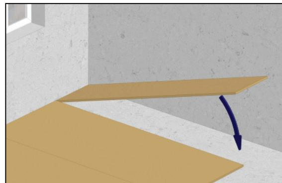
**1c** На пол укладывается полотно **SoundGuard Roll**, поверх него укладывается мягкая ДВП толщиной 10–12 мм.
