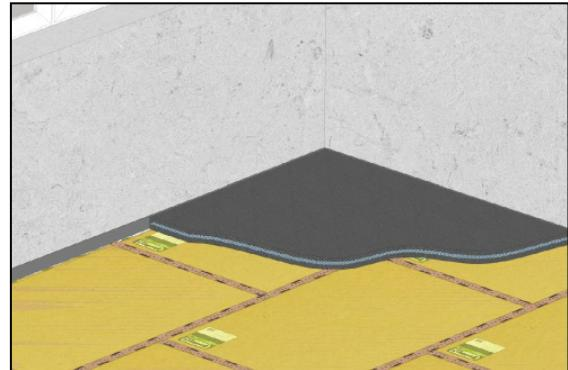
**5b** После полного высыхания поверхности на нее укладывается кафельная плитка согласно рекомендации производителя.
