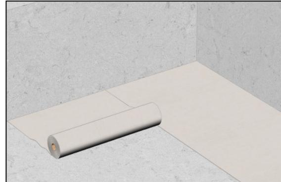
**1b** На пол укладывается мягкая ДВП толщиной 10–12 мм.
