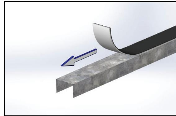
**3** Для уменьшения передачи структурного шума в точках крепления направляющего профиля применяется виброразвязывающая шайба **SoundGuard Vibro Washer** 8×18 с шагом 600 мм. При использовании виброразвязывающей шайбы диаметр отверстия в профиле под дюбель-гвоздь должен быть 10 мм. Боковая стенка направляющего профиля проклеивается демпферной лентой **SoundGuard**.
