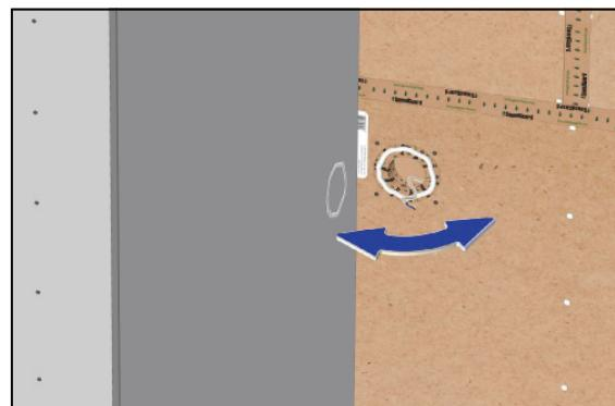
**14** В звукоизоляционный короб **SoundGuard IzoBox** монтируется подрозетник, который прикручивается двумя саморезами к внутренней плоскости короба.
